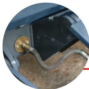
Konstrukcja przewodów ułatwiająca utrzymanie
